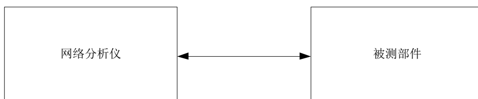
图2 反射损耗测量框图
